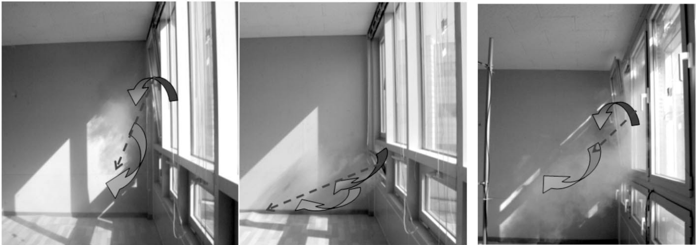
[그림 16] 자연환기시 연막실험. t&t 창(좌), 프로젝트창(중), 이중외피(우)
